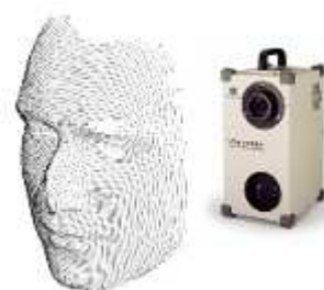
Nuage de points obtenu grâce à un scanner 3D
